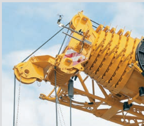
Poulie en extrémité de mât, rabattable sur le côté
